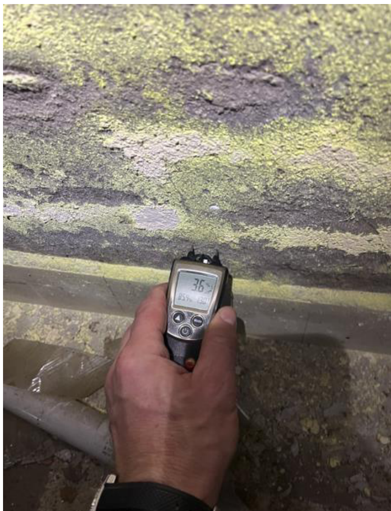
Fot. 19. Pomiar zawilgocenia ściany w piwnicy w osiach D'/16. Wilgotność przegrody w trakcie pomiaru wynosiła 3,6%.
