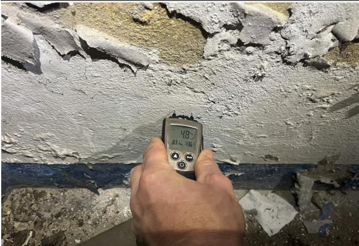
Fot. 20. Pomiar zawilgocenia ściany w piwnicy w osiach C'/18. Wilgotność przegrody w trakcie pomiaru wynosiła 4,8%.
